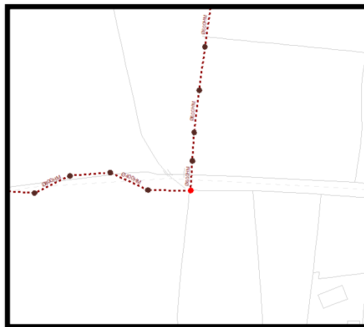
Fig 5.- Pozo de saneamiento de conexión para la acometida de aguas residuales del complejo. COD GIS 56225
